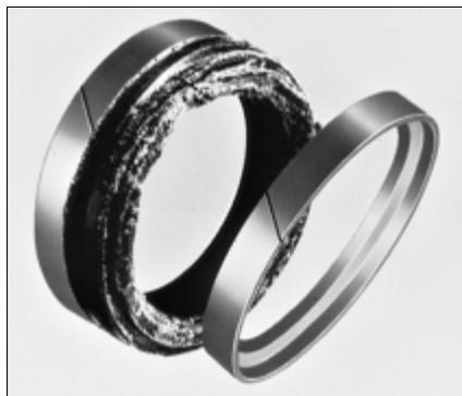
Рис. 4.18 Экструзивный износ компактного поршневого уплотнения
