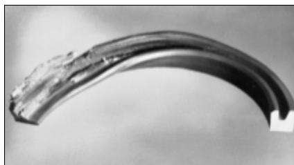
Рис. 4.12 Манжета, разрушенная из-за гидродинамического роста давления
