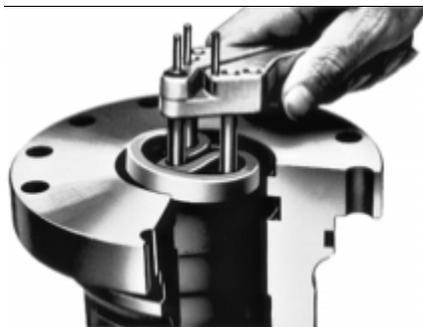
Рис. 4.24 Монтажный инструмент I для уплотнений штока
