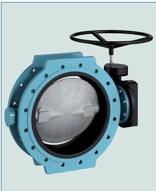
Двухфланцевый затвор с эластомерным уплотнением для применения на высоком давлении. Завулканизированная манжета и полнопроходной вал позволяют использовать затвор на рабочем давлении до 25 бар.
