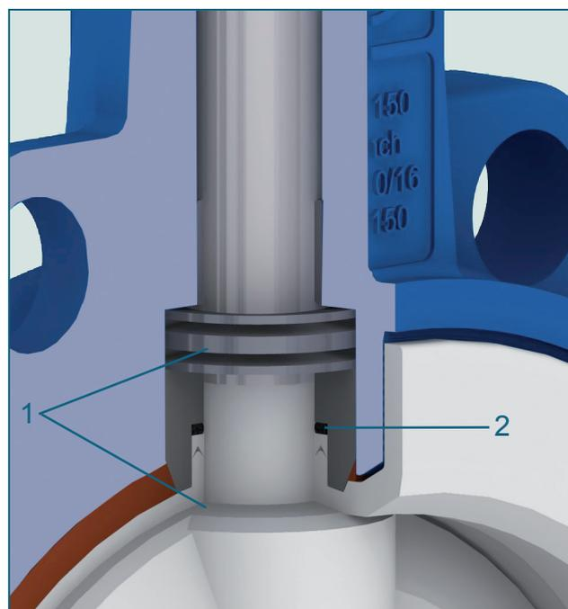
Безопасное уплотнение с двух сторон вала по принципу EBRO TWIN - Уплотнение:
