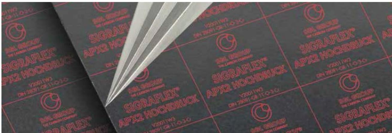
SIGRAFLEX® APX2 HOCHDRUCK - это многослойный высокопрочный лист, разработанный для применения при высоких температурах. Лист изготовлен по уникальной технологии SIGRAFLEX HOCHDRUCK и состоит из слоёв графитовой фольги SIGRAFLEX® APX2 толщиной 0,5 мм, стойкой к окислению, и армирующих слоёв нержавеющей стали толщиной 0,05 мм.
