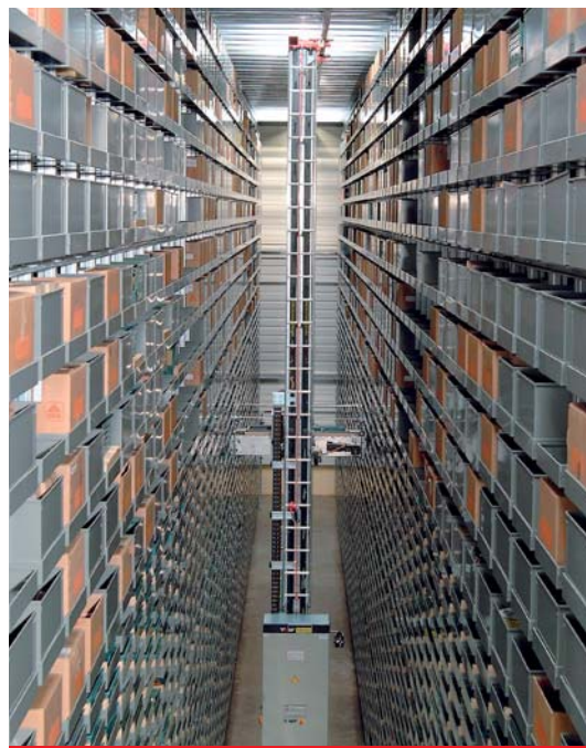
Полностью автоматизированный склад со стеллажами
