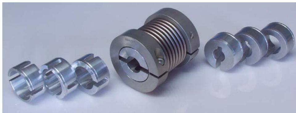
Металлический сильфон и зажимные кольца муфты smartflex® в пределах одного конструктивно-го размера для всех исполнений одинаковы. Адаптация под необходимый диаметр вала в каждом случае достигается переходной втулкой, которая просто и быстро фиксируется в зажимном кольце.
