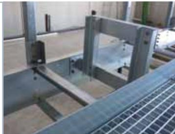
Опоры для транспортёра, выполнены из стали, оцинкованной горячим погружением, с регулируемой высотой.
