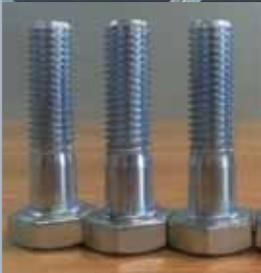
**Класс качества 8.8 и 10.9** (ISO 898 - 1:2009 и 898 - 2:2003). Оцинкованы горячим погружением, с покрытием 70 – 85 μm (Стандарт UNE – EN ISO 10684:2006).
